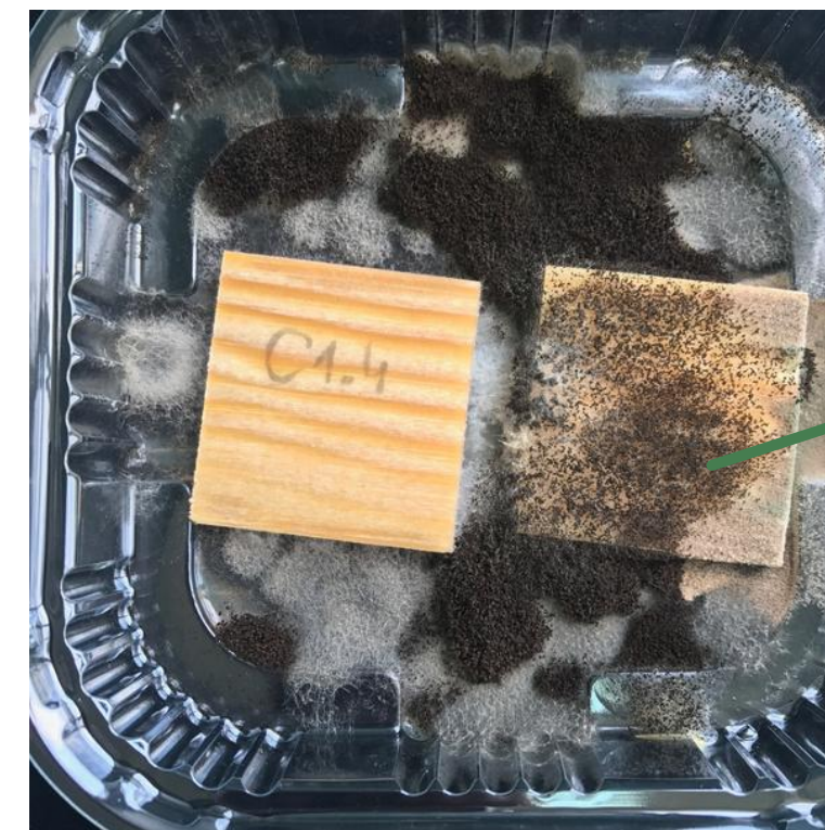
próbka kontrolna porośnięta A.niger
